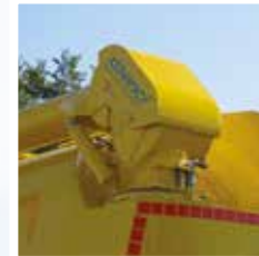
GEBOGENES ENDSTÜCK ENTLADEROHR, MECHANISCH, MIT AXIAL-KARDAN
