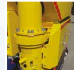
DREHMOMENTBEGRENZER (RUTSCHKUPPLUNG) AN DER DREHUNG DES VERTIKALEN ROHRS
