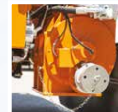
PNEUMATISCHE ENTLADEANLAGE MIT ZELLENRADSCHLEUSE
